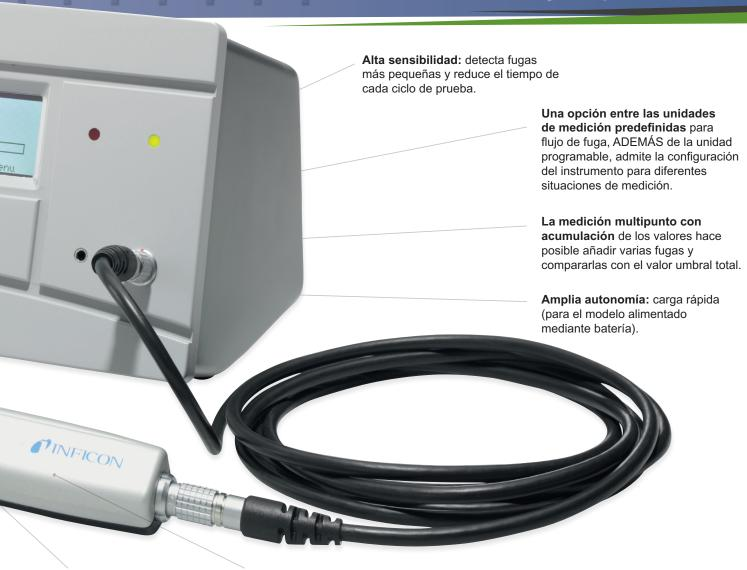
La puesta a cero automática y manual elimina problemas con altos niveles secundarios de gas trazador. Solo debe limitarse a pulsar un botón para eliminar alteraciones secundarias.
