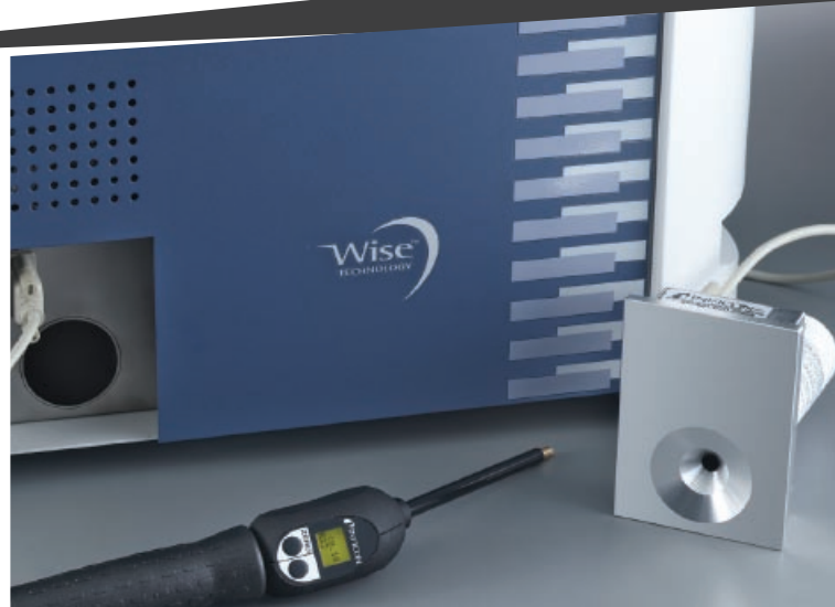
Fuga de prueba calibrada a distancia
