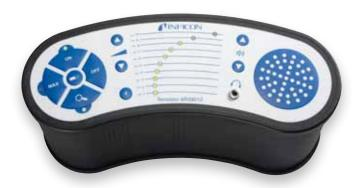
Um die präzise Lokalisierung großer und kleiner Lecks zu ermöglichen, kann die Empfindlichkeit des XRS9012 über einen sehr weiten Bereich eingestellt werden. Der elektronische Sensor im Messkopf spricht sofort auf austretendes Prüfgas an und das Signal klingt so schnell wieder ab, dass unverzüglich eine neue Messung durchgeführt werden kann.
