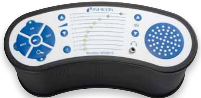
mantenimiento. Para poder detectar tanto fugas de poca importancia como las de mayor gravedad, el detector Sensistor XRS9012 incluye un ajuste de sensibilidad con el fin de adaptarse de forma instantánea a cualquier condición de detección. El sensor electrónico montado en el extremo de la sonda responde de forma instantánea al gas trazador; además, el instrumento cuenta con un tiempo de recuperación muy corto para que puedan realizarse nuevas mediciones de forma inmediata.
