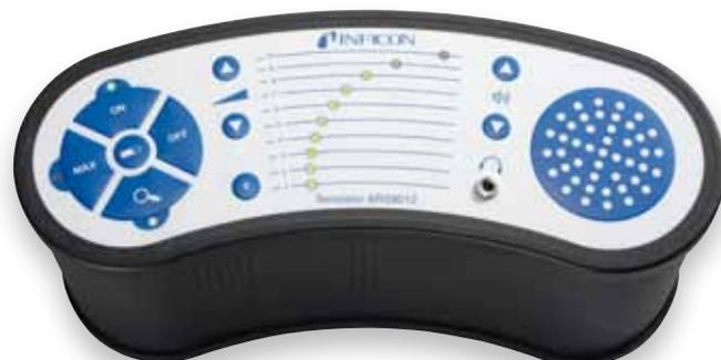
Per consentire la rilevazione sia di micro che di macroperdite, Sensistor XRS9012 dispone di un regolatore di sensibilità e si adatta immediatamente ad ogni situazione. Il sensore elettronico è posto sulla punta della sonda reagendo così in maniera istantanea al gas tracciante. Lo strumento vanta inoltre un tempo di recupero molto breve consentendo così di procedere immediatamente a nuove misurazioni.
