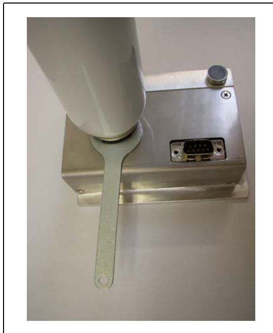
Abb. 7-19 Installieren des Gasspeichers
