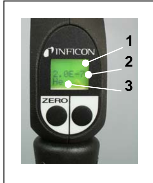
Abb. 3-5 Display im Handgriff der Sonde im Standardbetrieb
