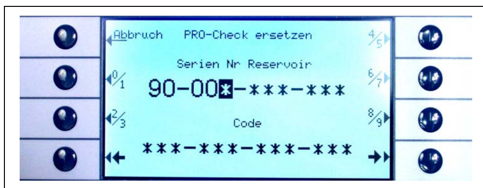
Abb. 1-5 Das PRO-Check Referenzleck initialisieren
