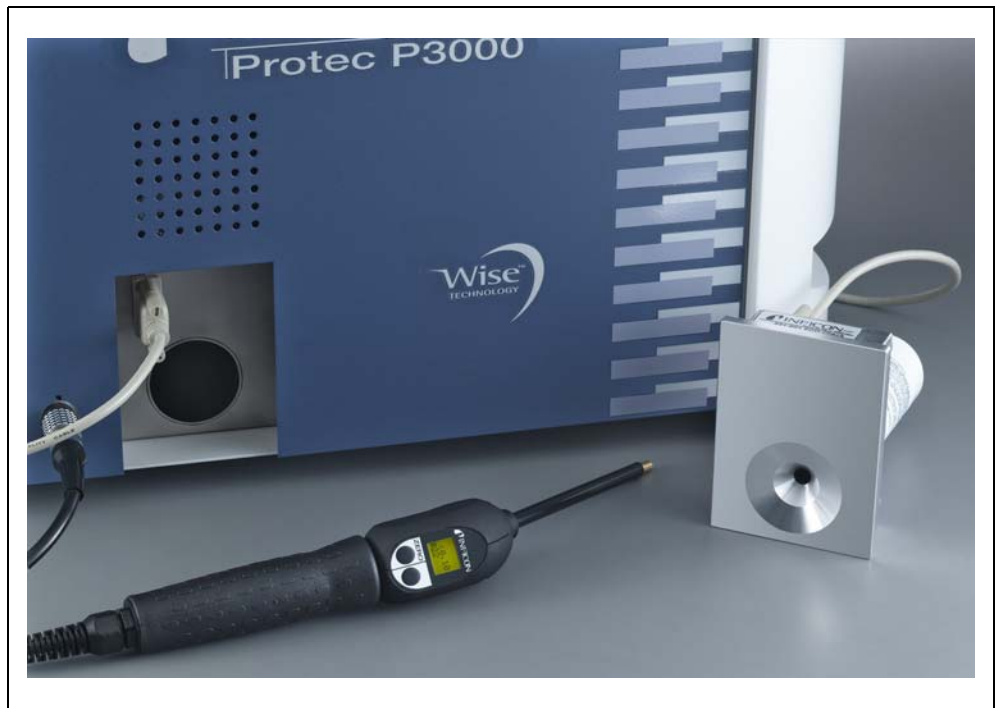
Abb. 2-6 PRO-Check Referenzleck zur Verwendung an anderer Stelle aus dem Hauptgerät herausgenommen
