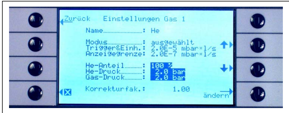
Abb. 4-5 Einstellen eines Kältemittelkorrekturfaktors
