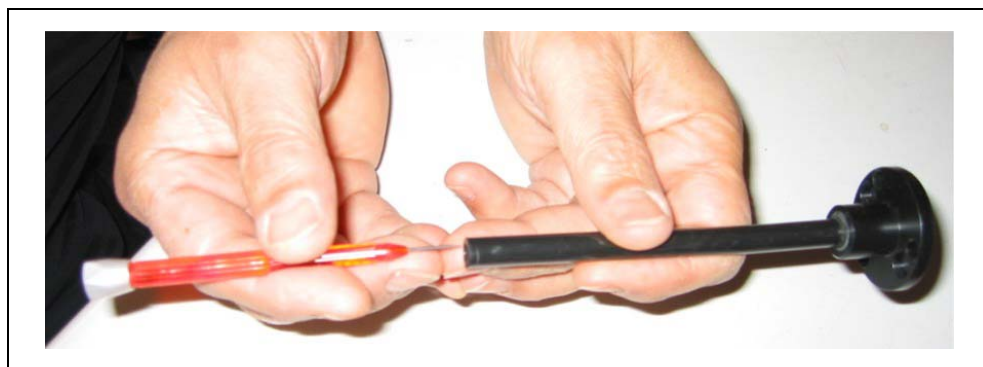
Abb. 7-15 Herausschieben des Stahlkapillars
