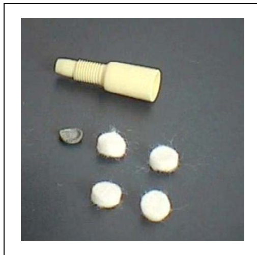
Abb. 7-7 Altes und neues Filzfilter
