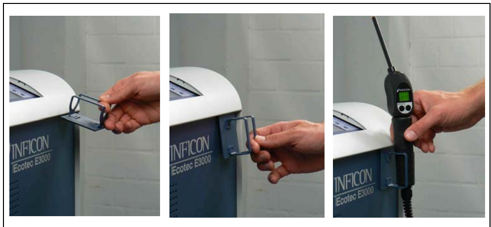
Abb. 1-8 Installation des Schnüffelleitungshalters
