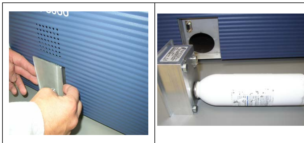
Abb. 7-17 Entnahme des PRO-Check Referenzlecks aus dem Hauptgerät
