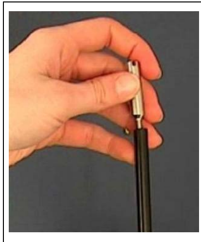
Abb. 1-4 Installation der Wasserschutzspitze
