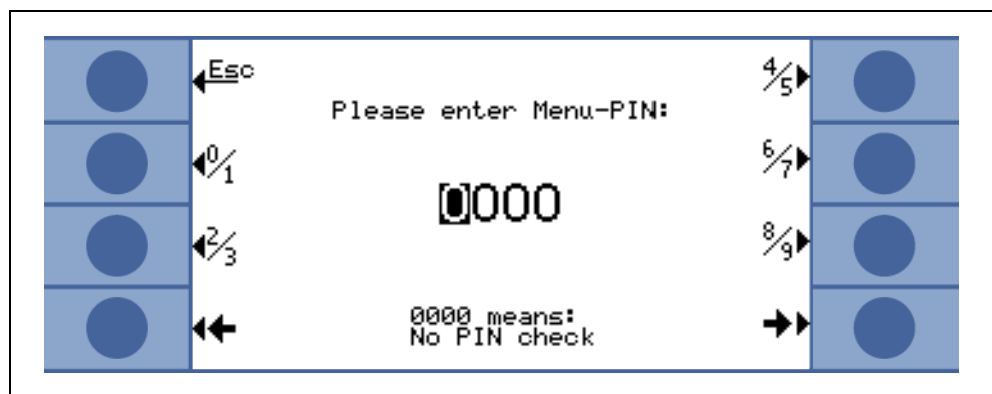
Fig. 4-14 Setting-up a Menu-PIN for parameter protection
