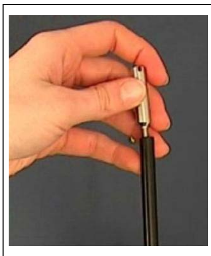
Fig. 1-4 Instalando la punta de protección contra el agua
