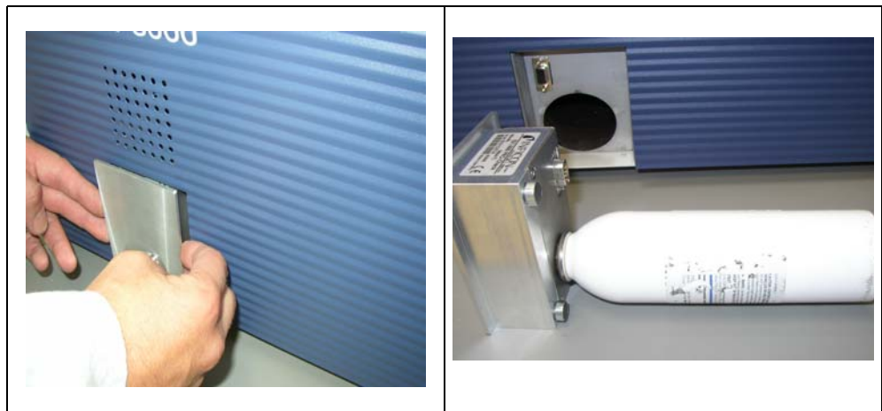
Fig. 7-17 Extrayendo la fuga de referencia PRO-Check de la unidad principal.
