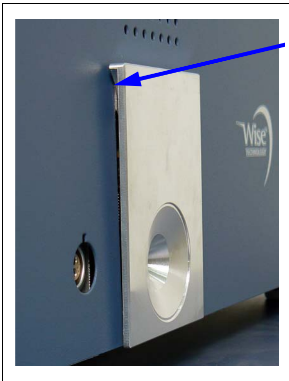
Fig. 7-20 Espacio entre el PRO-Check y el panel frontal
