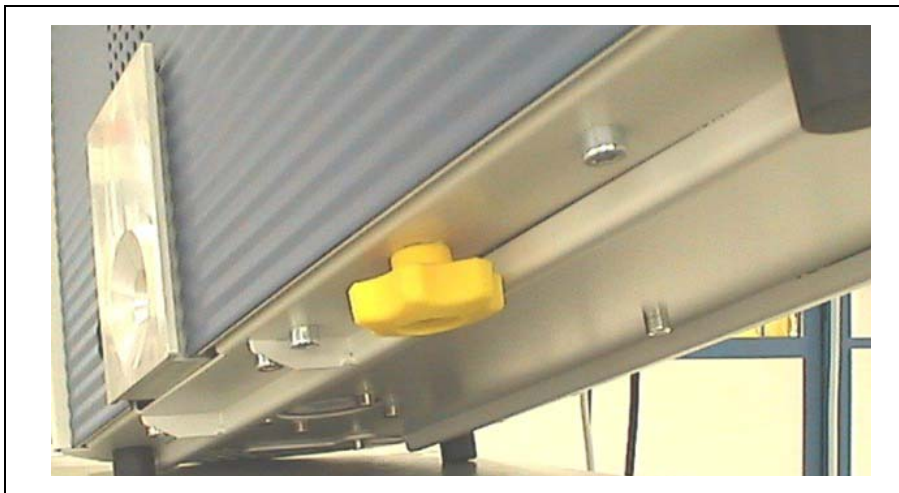
Fig. 1-3 Retirar el seguro de transporte antes de la puesta en servicio
