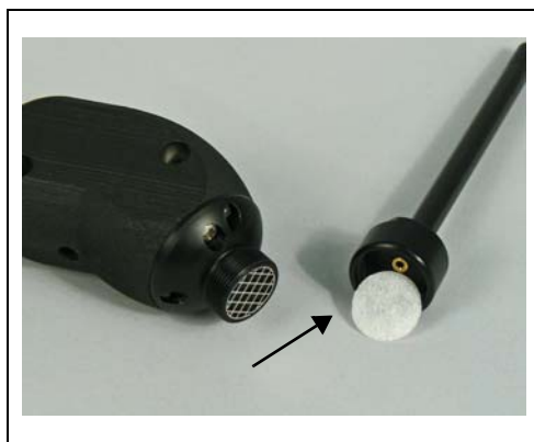
Fig. 7-11 Almohadilla del filtro extraída
