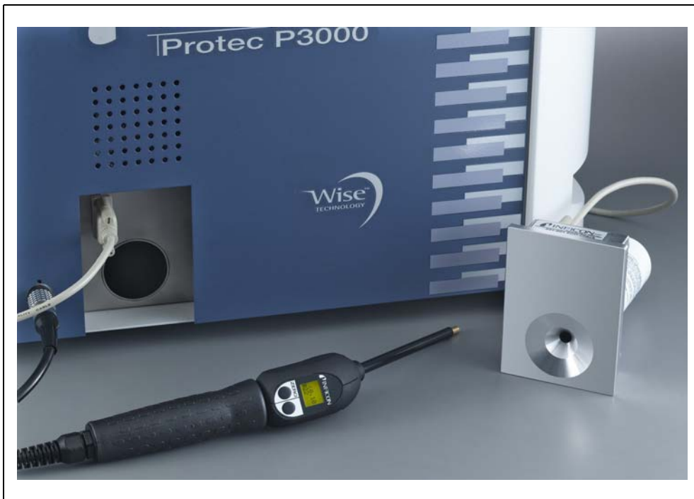
Fig. 2-6 Fuga de referencia PRO-Check separada de la unidad principal para uso a distancia
