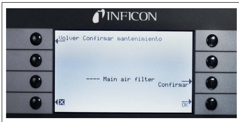
Fig. 4-26 Confirmación del trabajo de mantenimiento
