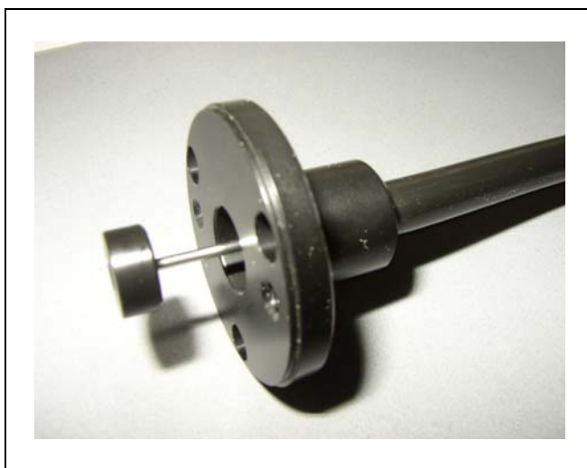
Fig. 7-16 Capilar de acero sobresaliendo de la brida de la punta del sorbedor
