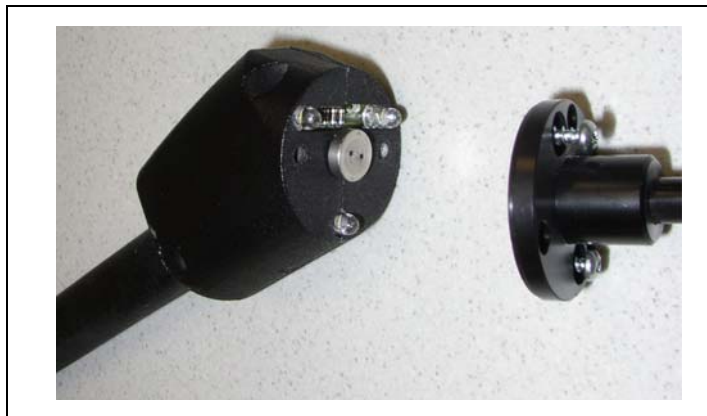
Fig. 7-8 Extrayendo la punta del sorbedor
