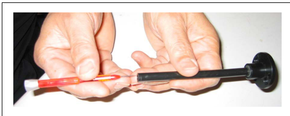
Fig. 7-15 Expulsión del capilar de acero
