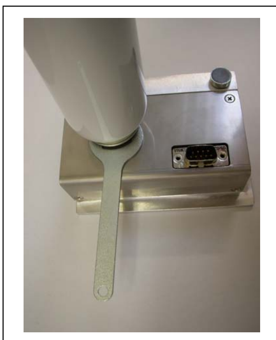
Fig. 7-19 Instalación del depósito de gas
