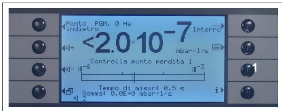
Fig. 3-7 Schermata di misurazione in modalità I•Guide
