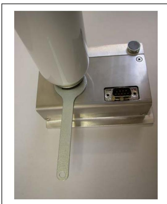
Fig. 7-19 Installazione del serbatoio di gas
