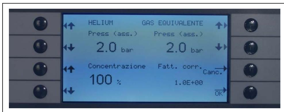
Fig. 4-7 Modifica di parametri per valori di fuga equivalenti in refrigeranti
