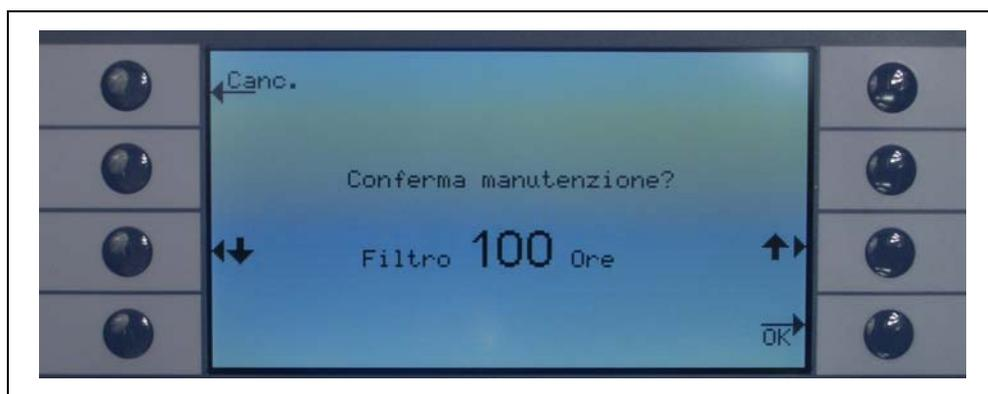
Fig. 4-23 Impostazione dell'intervallo di manutenzione per il filtro del puntale del cercafughe e conferma della sostituzione
