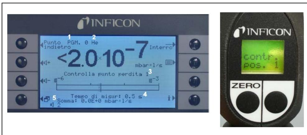
Fig. 3-9 Schermi della guida I•Guide durante la misurazione
