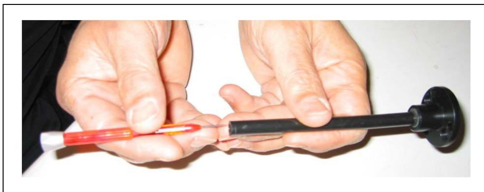
Fig. 7-15 Estrazione del filtro capillare
