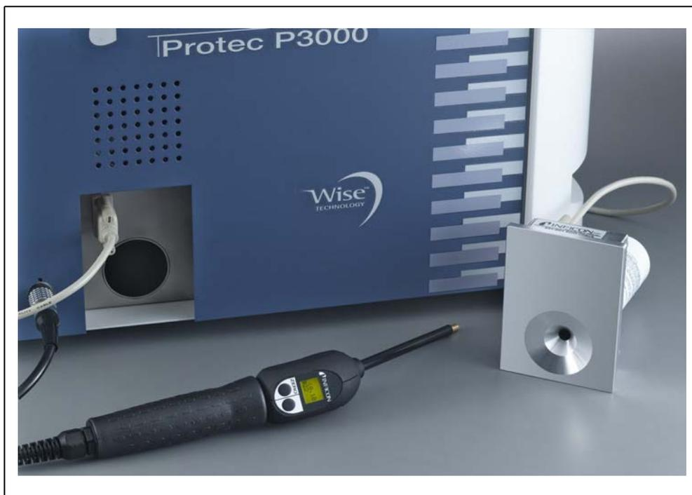
Fig. 2-6 PRO-Check separata dall'unità principale per impiego remoto
