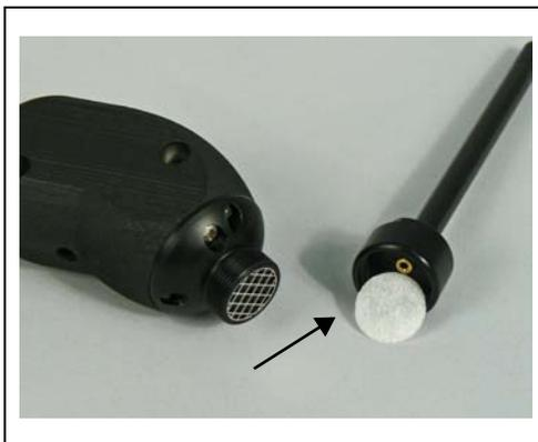
Fig. - 7-11 Rimuovere il pad del filtro
