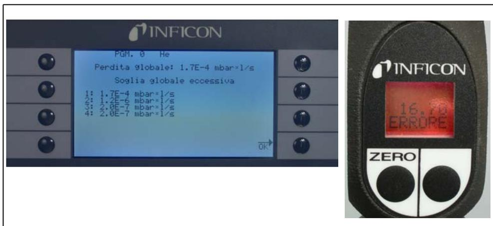
Fig. 3-12 Risultato del programma I•Guide: l'unità in collaudo è stata approvata
