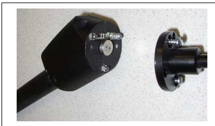
Fig. 7-8 Smontare il puntale dell'annusatore
