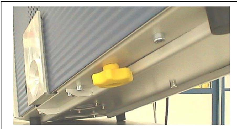
Fig. 1-3 Rimozione del fermo da trasporto prima dell'avvio
