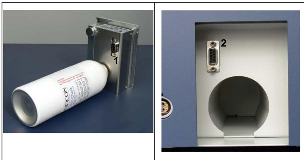
Fig. 2-7 Connessioni per uso remoto
