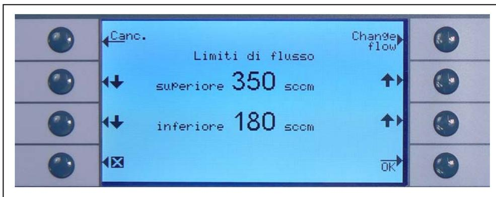
Fig. 4-11 Come modificare i limiti del flusso della linea dello sniffer SL3000
