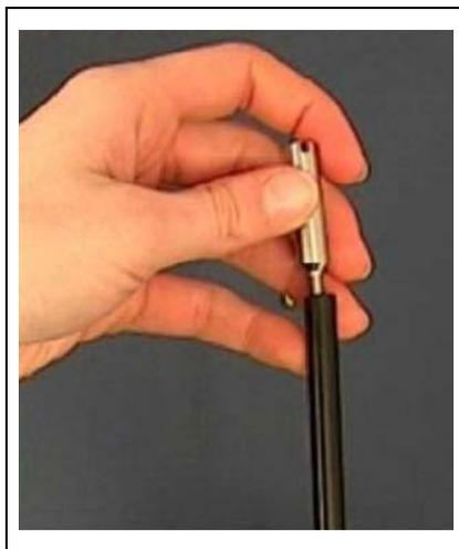
Fig. 1-4 Installazione del puntale di protezione dell'acqua
