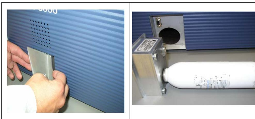
Fig. 7-17 Rimozione del campione di fuga PRO-Check dall'unità principale
