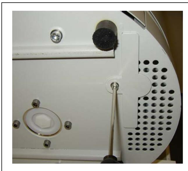
Fig. 7-1 Il fermo del filtro dell'aria si trova in basso sul rilevatore di fughe
