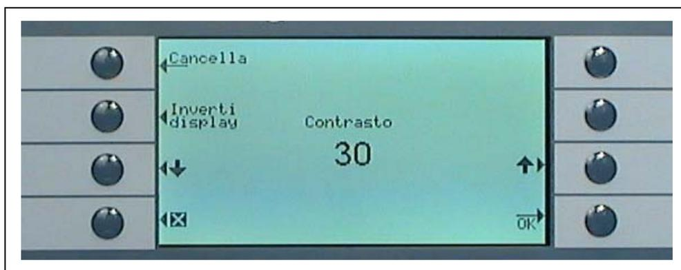
Fig. 4-16 Come configurare il contrasto del display principale
