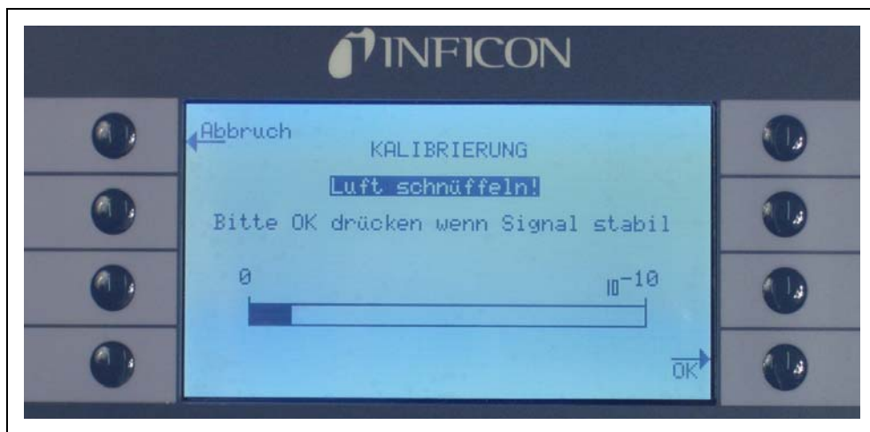
Fig. 3-20 Żądanie pobrania powietrza podczas kalibracji zewnętrznej
