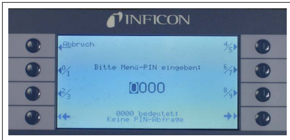
Fig. 4-15 Ustawianie kodu PIN menu dla zabezpieczenia parametrów
