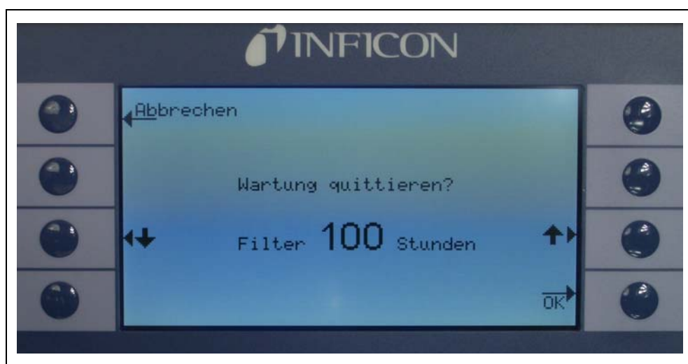
Fig. 4-23 Określanie częstotliwości KONSERWACJI (WARTUNG) dla filtra końcówki czujnika i jej zatwierdzenie
