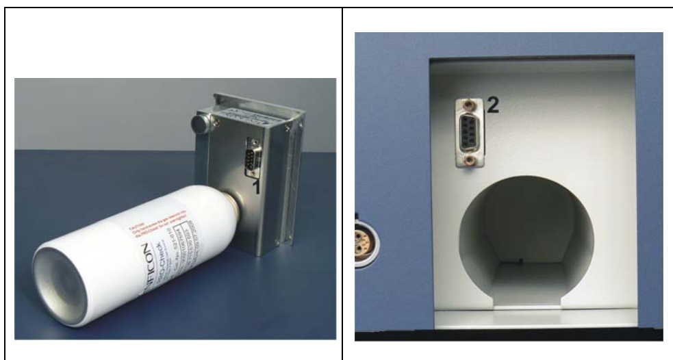
Fig. 2-7 Złącza do zdalnego użycia nieszczelności referencyjnej
