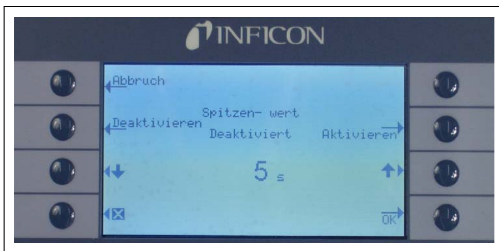
Fig. 4-17 Konfiguracja funkcji zatrzymywania WARTOŚCI SZCZYTOWEJ (SPITZENWERT)
