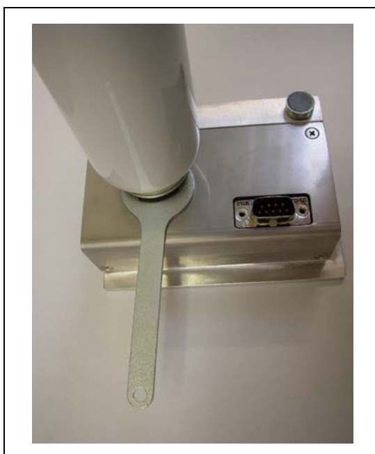
Fig. 7-19 Montaż pojemnika na gaz
