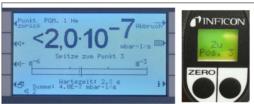
Fig. 3-10 Ekrany I•Guide z żądaniem przejścia do kolejnego miejsca pomiarowego
