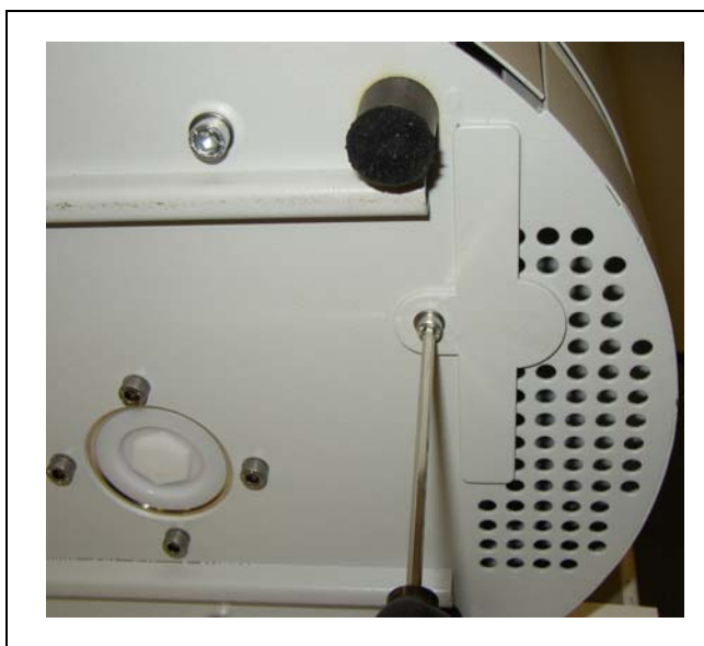
Fig. 7-1 Mocowanie filtra powietrza na spodzie detektora nieuszczelności
