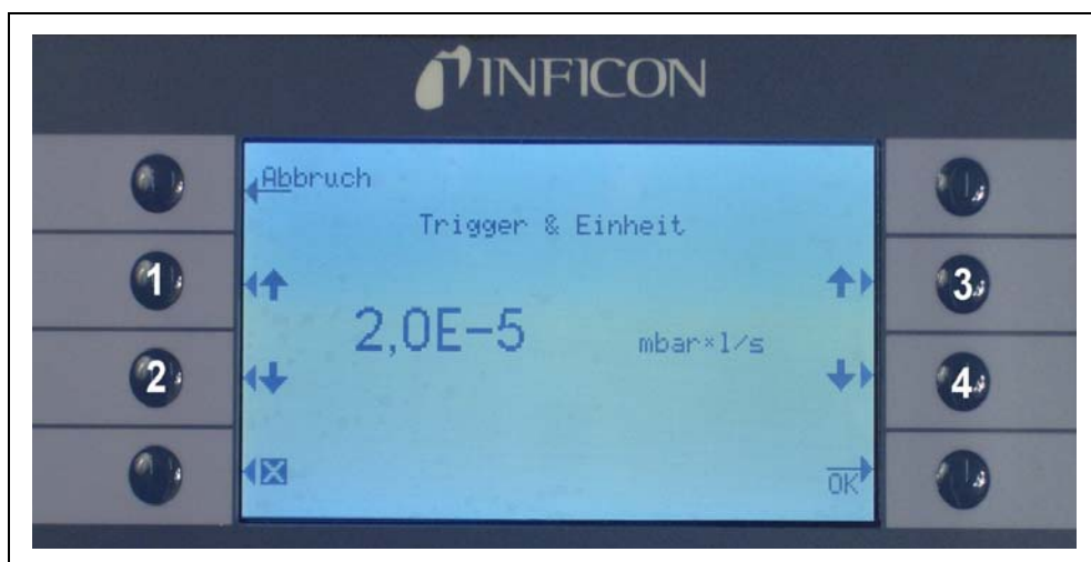
Fig. 4-8 Ustawianie poziomu wyzwalania oraz jednostki (Trigger &amp; Einheit) pomiaru
