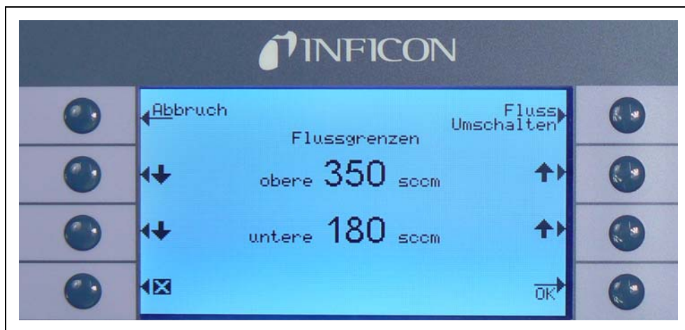
Rys. 4-11 Zmiana wartości granicznych przepływu (Flussgrenzen) dla przewodu czujnika SL3000
