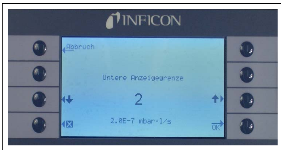
Fig. 4-9 Edytowanie dolnej granicznej wartości wskazania (Untere Anzeigegrenze)
