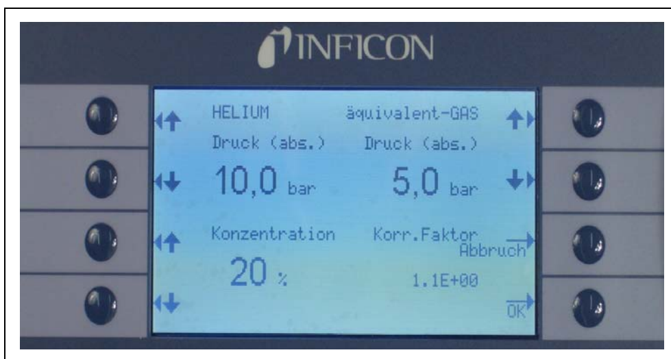
Fig. 4-7 Edytowanie parametrów dla wartości nieszczelności zamienników chłodziwa
