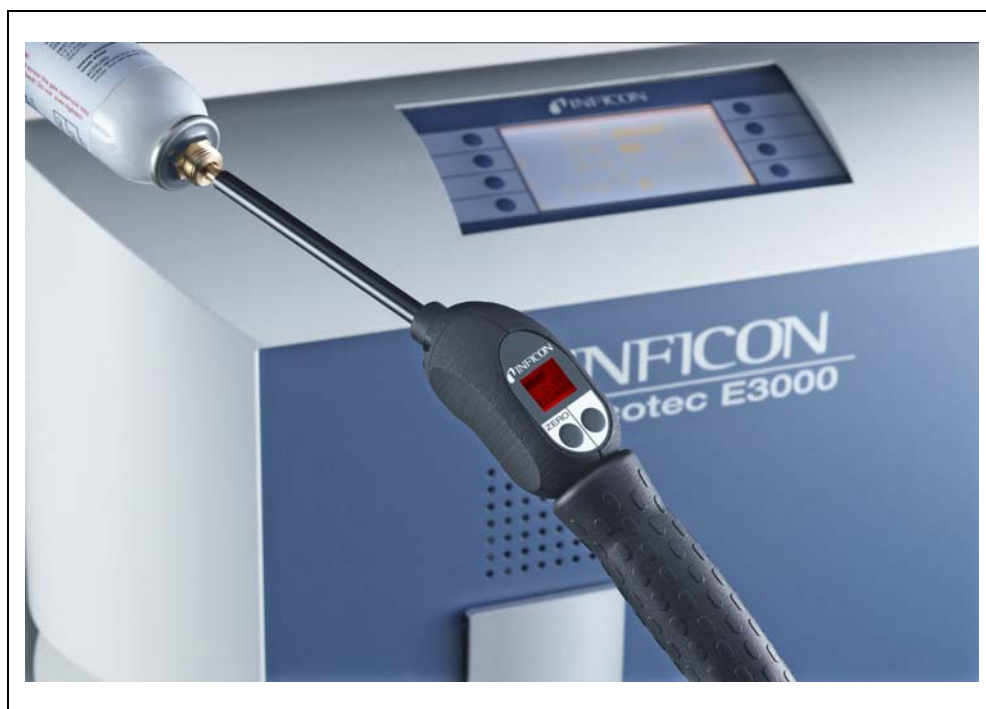
Fig. 3-5 Wyświetlacz na uchwycie w momencie wykrycia nieszczelności
