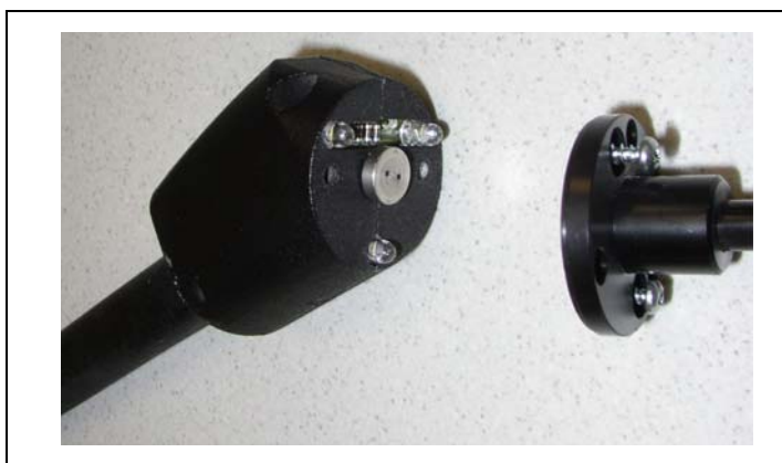
Fig. 7-8 Demontaż końcówki czujnika
