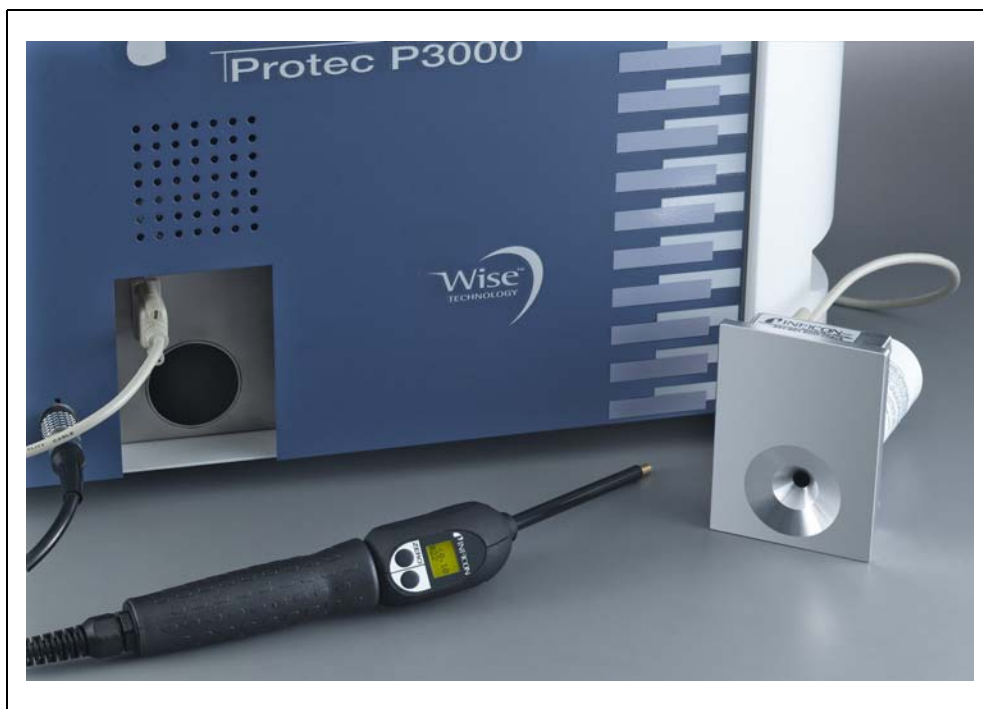
Fig. 2-6 Nieszczelność referencyjna PRO-Check zdemontowana z urządzenia głównego w celu użycia zdalnego
