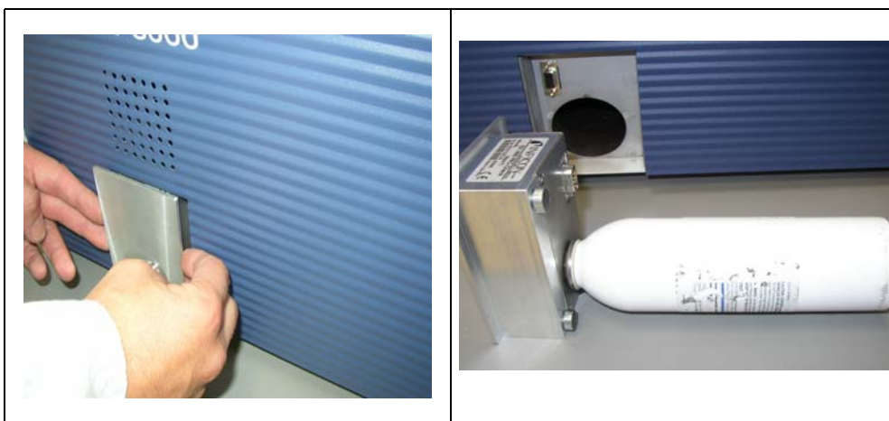
Fig. 7-17 Demontaż nieszczelności referencyjnej PRO-Check z urządzenia głównego
