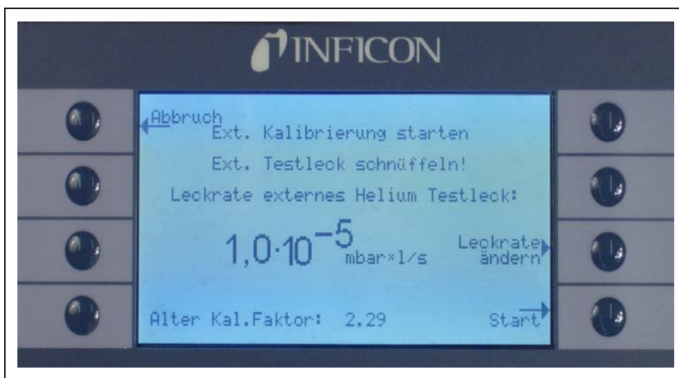
Fig. 3-18 Ustawianie wartości nieszczelności dla zewnętrznej nieszczelności testowej
