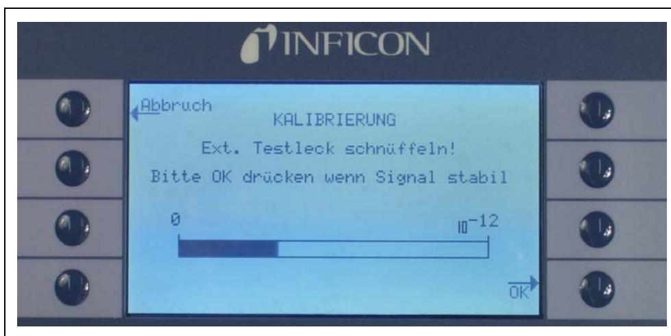
Fig. 3-19 Ekran Kalibracji (KALIBRIERUNG) podczas kalibracji zewnętrznej
