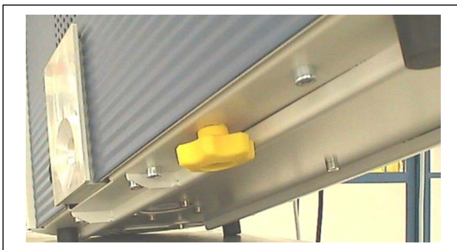
Fig. 1-3 Usuwanie zabezpieczenia transportowego przed uruchomieniem.
