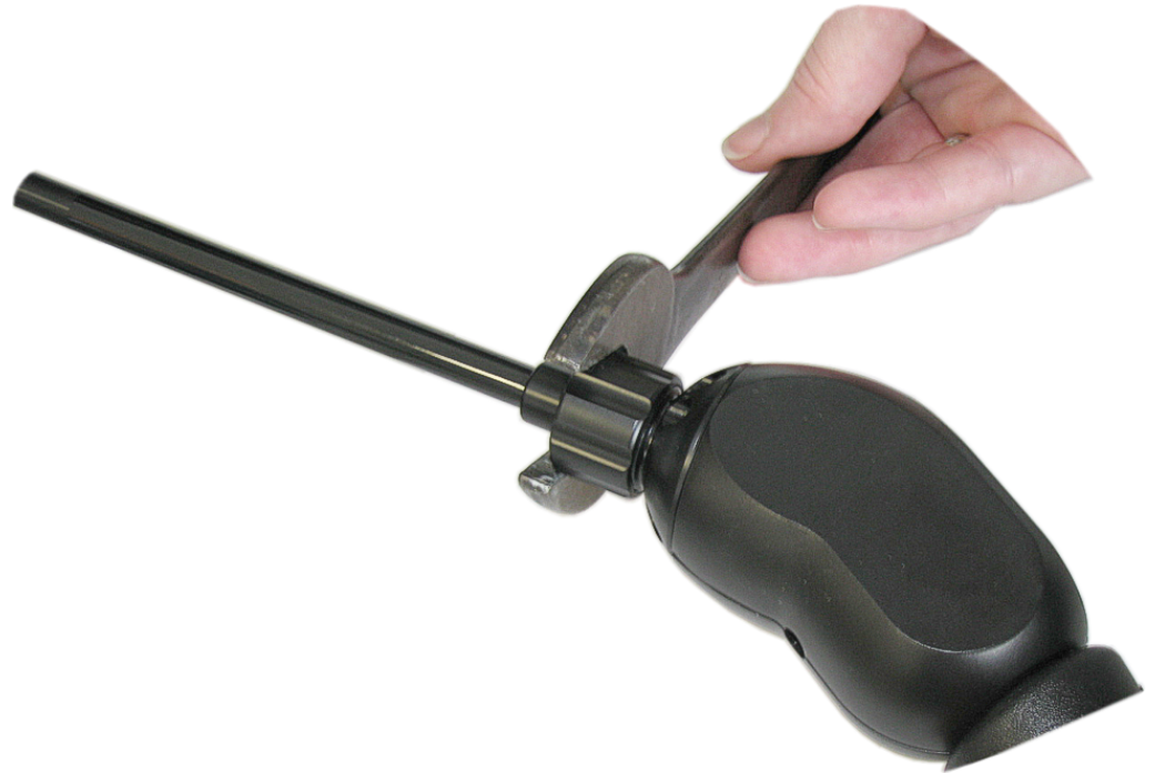
Abb. 12: Hutmutter der Schnüffelspitze lösen
