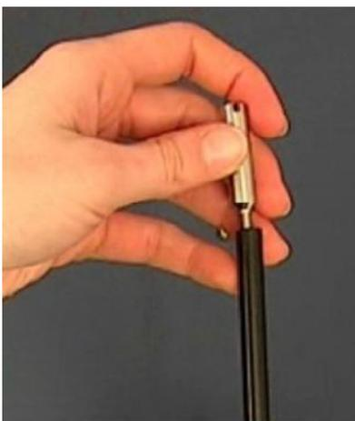
Abb. 8: Wasserschutz-Schnüffelspitze festschrauben
