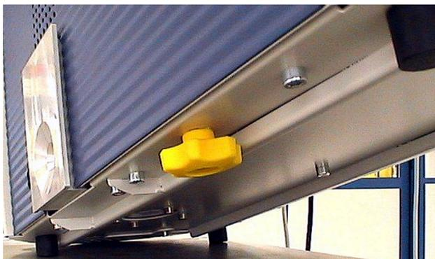
Abb. 5: Gelbe Transportsicherung vor Inbetriebnahme heraus-schrauben
