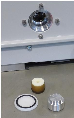
*Abb. 49: Geöffneter Betriebsmittelspeicher*
