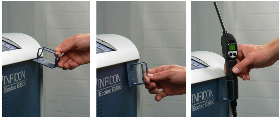
Abb. 9: Schnüffelleitungs-Halter montieren
