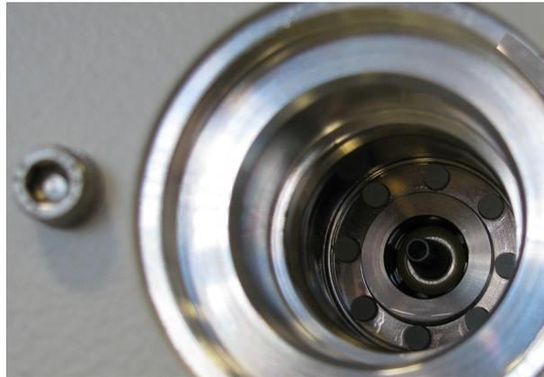
Abb. 50: Porexstäbe des Betriebsmittelspeichers
