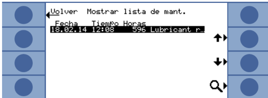
Fig. 43: Entradas de una lista de mantenimiento
