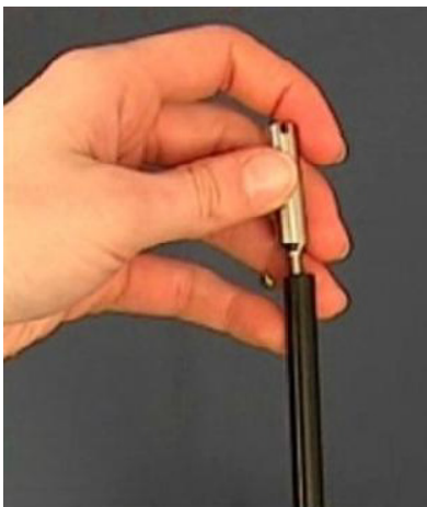
Fig. 8: Enrosca la punta adicional de protección contra el agua
