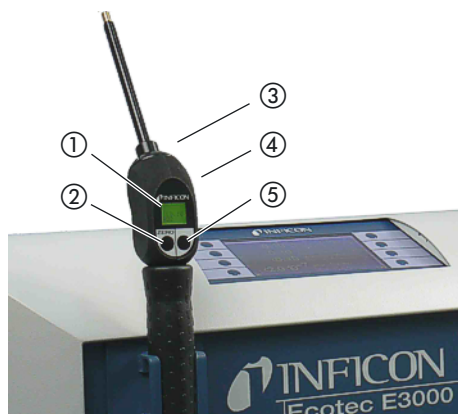
Fig. 4: Mango: pantalla y funciones
