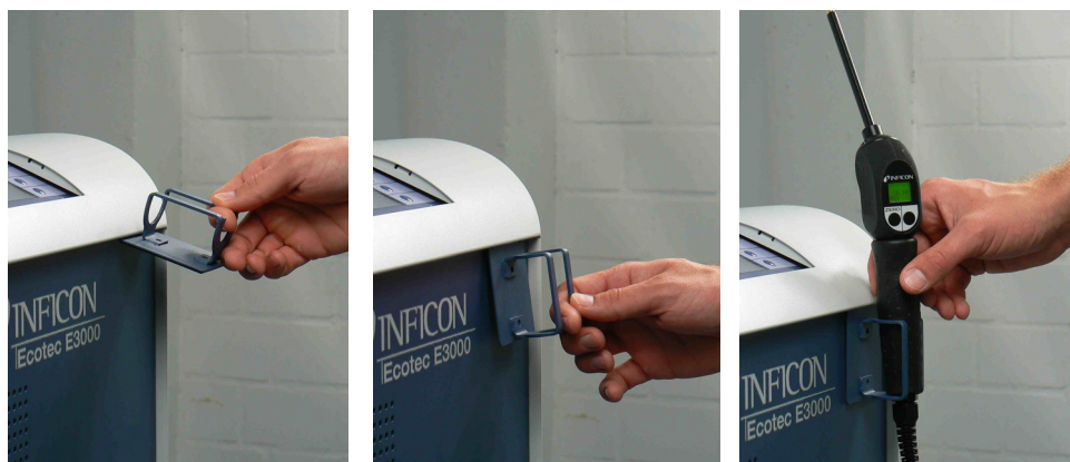
Fig. 9: Montar el soporte del conducto de aspiración
