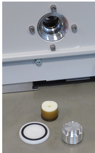
Fig. 49: Depósito de lubricante abierto
