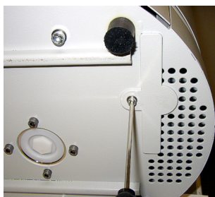
Fig. 46: Desserer le cache du filtre à air.
