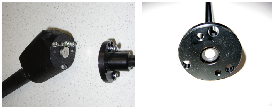
Fig. 55: Filtration Sinter dans la poignée de renifleur
