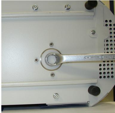
Fig. 48: Chiusura del serbatoio del mezzo d'esercizio
