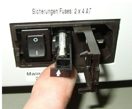
Fig. 52: Inserto con fusibile
