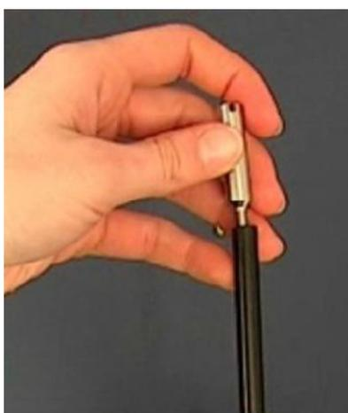
Fig. 8: Serraggio del puntale sniffer antiassorbimento
