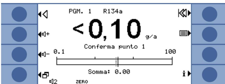
Fig. 33: Indicatore di misura in un programma I-Guide
