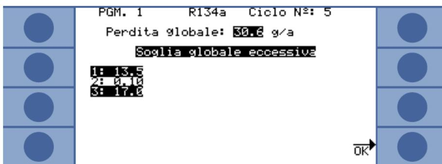
Fig. 37: Ricerca del gas R134a con il programma I-Guide 1: sui punti di misura 1 e 3 è stato superato il valore trigger e il tasso di perdita totale è stato superato.
