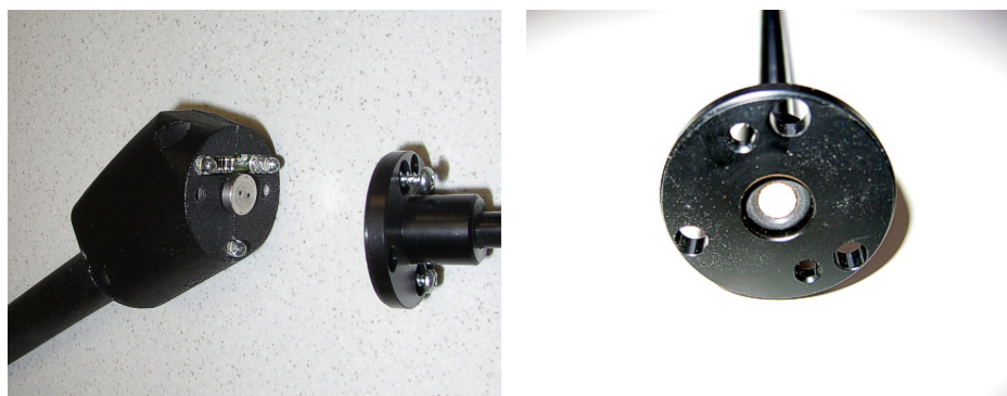
Abb. 55: Filtr z węglików spiekanych zainstalowany w uchwycie przyrządu kontrolnego nieszczelności
