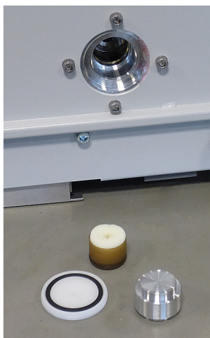
Abb. 49: Otwarty zbiornik płynu roboczego
