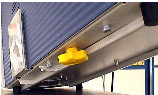
Abb. 5: Przed uruchomieniem przyrządu należy zdemonstrować zabezpieczenie transportowe
