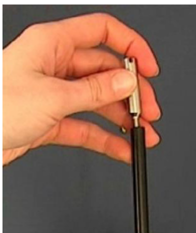
Abb. 8: Przykręcanie końcówki stożkowej ochronnej przed wodą
