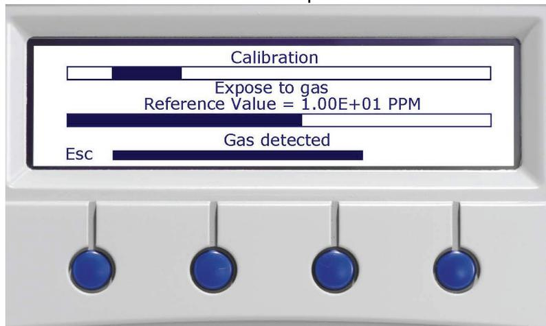
Die Länge des Balkens zeigt den Zustand des Sensors an. Der Balken wird kürzer, wenn der Sensor weniger empfindlich arbeitet. Die Skalierung der Anzeige ist nicht so präzise, dass genau gesagt werden können, bei welcher Länge der Sensor ausgetauscht werden muss. Sie werden die entsprechende Erfahrung mit Ihrer Anwendung machen. Am Instrument wird in Klartext angezeigt, dass die Empfindlichkeit zu gering ist. Weitere Angaben hierzu entnehmen Sie bitte dem folgenden Abschnitt.
