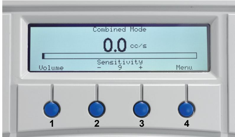
Für den Zugriff auf die Menüs drücken Sie Menü (Taste 4). Mit den Tasten < und > (Taste 2 und Taste 3) wechseln Sie zwischen den Hauptmenüs.
