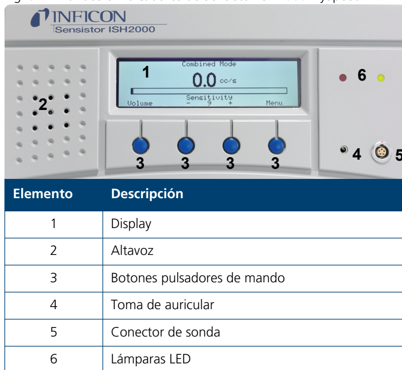
Fig. 3-1. Mandos e indicadores de Sensistor ISH2000 HySpeed.
