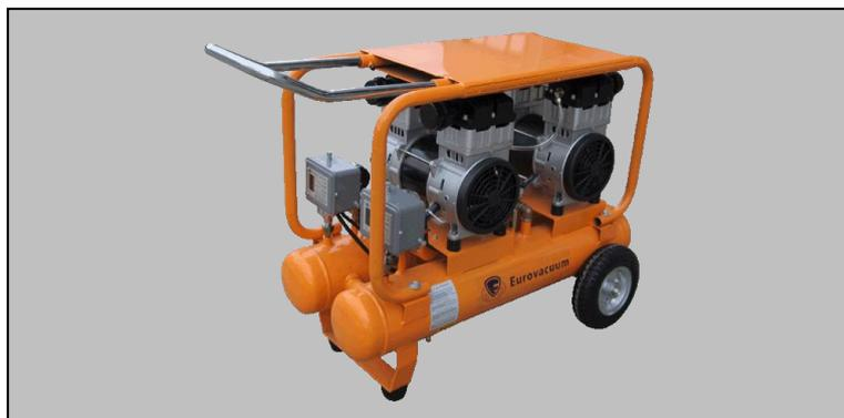
Sistema compatto per due differenti livelli di vuoto con due pompe vuoto a pistone, due serbatoi da 12 lt. ognuno, due vacuostati per la gestione separata del vuoto compreso tra 100 e 1000 mbar. Questa unità permette di operare con due diversi valori di vuoto indipendenti l'uno dall'altro, ed è dotata di una valvola di scambio che mette in collegamento i due sistemi per sfruttare all'occorrenza tutta la portata delle due pompe e la doppia capacità dei serbatoi in una soluzione unica..
