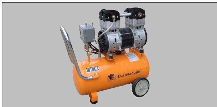
Sistema compatto di vuoto con pompa a pistone, serbatoio 30 lt, vacuostato automatico che permette la regolazione del vuoto in valori compresi tra 100 e 1000 mbar così come l'avvio e la fermata della pompa. Questa unità può montare diverse grandezze di pompe per vuoto a pistoni.
