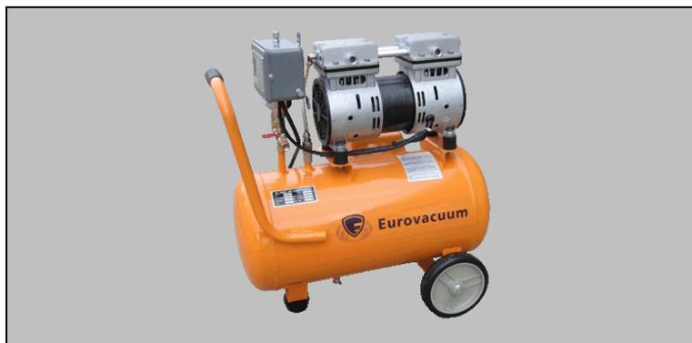
Sistema compatto di vuoto con pompa a pistone, serbatoio 24 lt, vacuostato automatico che permette la regolazione del vuoto in valori compresi tra 100 e 1000 mbar così come l'avvio e la fermata della pompa. Questa unità può montare diverse grandezze di pompe per vuoto a pistoni.
