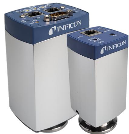
Das invertierte Magnetron Vakuummessgerät Gemini™ von INFICON ist das neue Arbeitspferd für alle Vakuummessapplikationen. Während Gemini MPG50x zwei Sensorsysteme zu einem kompakten Gerät für die Messung im Bereich von Atmosphäre bis  $1 \times 10^{-9}$  mbar vereinigt, ist Gemini™ MAG50x eine reine Kaltkathode (ohne Pirani), welche den Messbereich von  $1 \times 10^{-2}$  mbar bis runter zu  $1 \times 10^{-9}$  mbar abdeckt.
