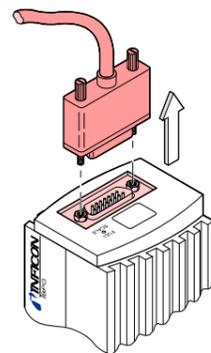
4 Messröhre vom Vakuumsystem demontieren.
