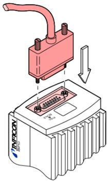
3 Kabeldose an der Messröhre mit den Arretierungsschrauben sichern.
