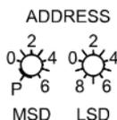
Die Knotenadresse (0 ... 63<sub>dec</sub>) muss mit den Schaltern <ADDRESS>, <MSD> und <LSD> eingestellt werden. Dieser Wert wird bei der Initialisierung der Messröhre von der Firmware abgefragt. Weicht dieser Wert von dem gespeicherten Wert ab, wird der neue Wert im NVRAM gespeichert. Falls eine Adresse größer als 63 eingestellt wurde, gilt der bereits gespeicherte Wert als Adresse.
