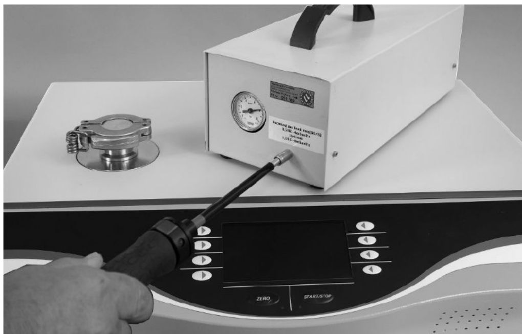
Abb. 12: Schnüffelprüfung am externen Prüfleck
