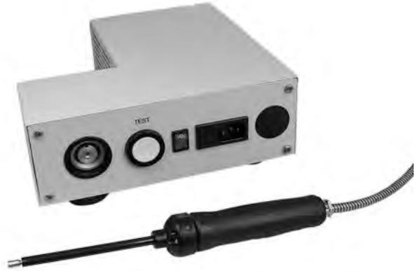
Helium-Schnüffler QUICK-TEST QT100 mit Schnüffler
