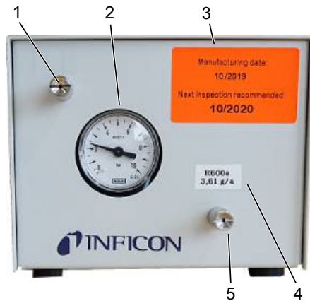
Abb. 1: Prüfleck mit Prüfmesssstelle
