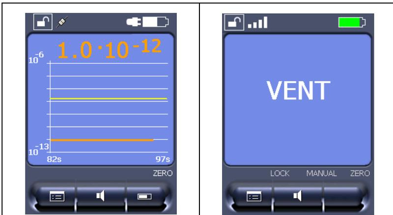
Fig. 27 Affichage des états Mesurer (diagramme d'évolution) et Ventilé
