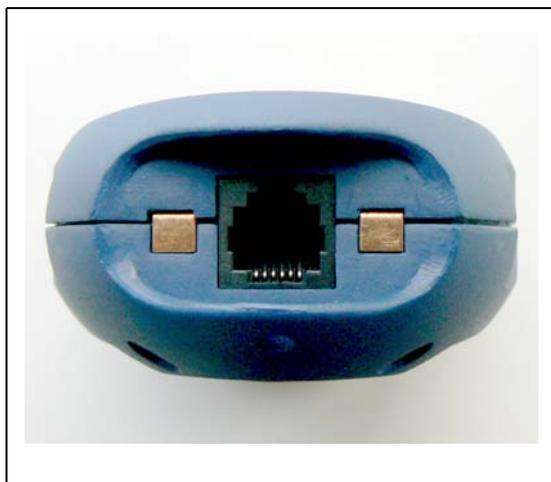
Fig. 4 Prise RJ25 sur la face inférieure de la télécommande
