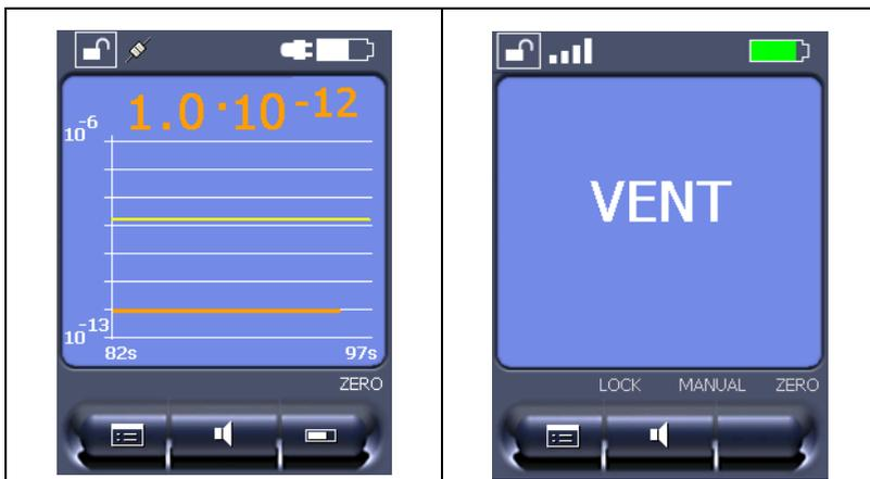
Fig. 27 „Measure“ (curve) and „Vented“ status displays
