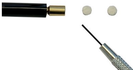
Fig. 1: Embout de renifleur SL3000 avec filtres en coton retirés
