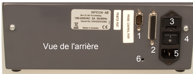
Fig 3-2. Ports et connexions de l'Sensistor ISH2000.
