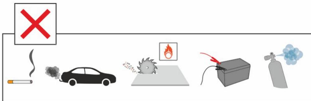
Evitare di posizionare lo strumento vicino a fonti di idrogeno, come il fumo di sigaretta, i motori a combustione, la lavorazione dell'alluminio, i punti di ricarica di batterie al piombo e, in alcuni casi, gli impianti ad aria compressa.
