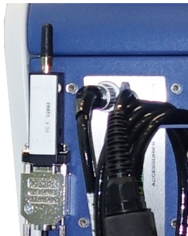
圖 20: 用魔術貼將變送器固定在自由的地方
