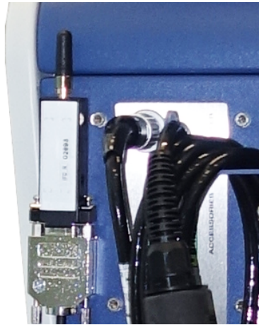
Fig. 20: Fixation de l'émetteur à l'aide de bande Velcro à un endroit libre
