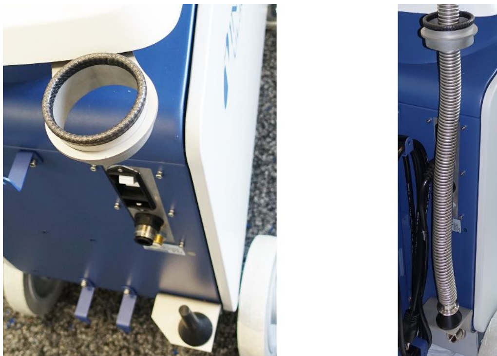
Fig. 8: Il supporto per tubo corrugato è installato.
