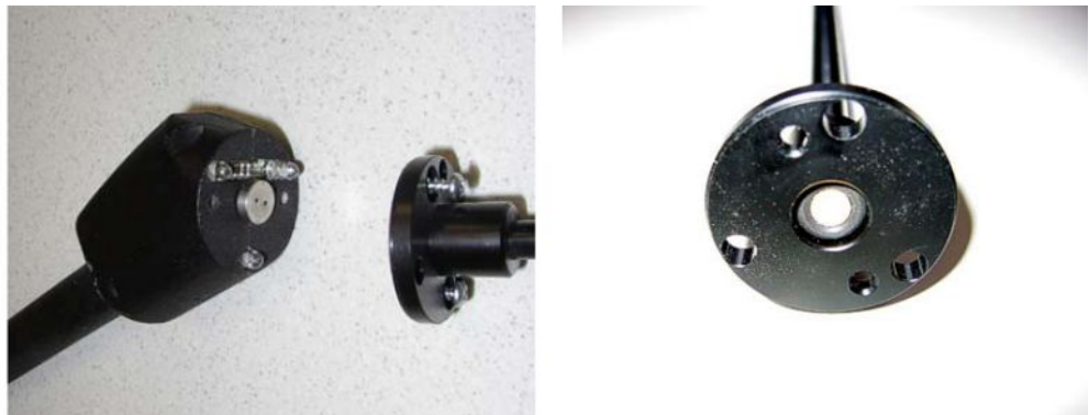
Fig. 18: Filtro di sinterizzazione nell'impugnatura sniffer
