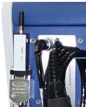
Fig. 20: Fissaggio del trasmettitore con nastro velcro in un punto libero
