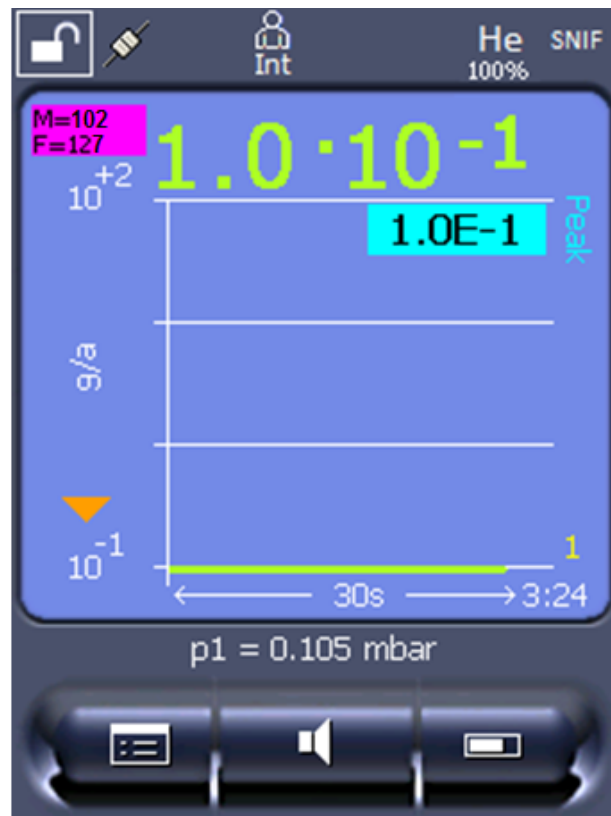
Fig. 4: In alto a sinistra: Visualizzazione della massa molare (102) e del fattore di equivalenza (127)
