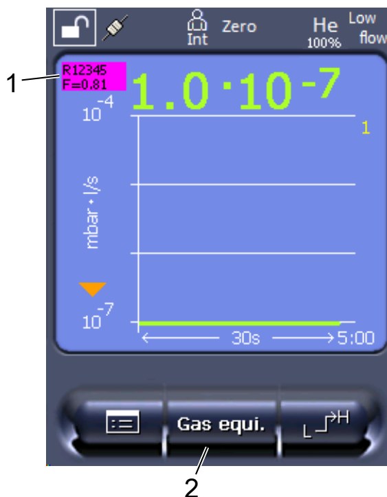
Fig. 3: Schermata di misurazione con visualizzazione del tasso di perdita di equivalenza e impostazione del pulsante Preferiti
